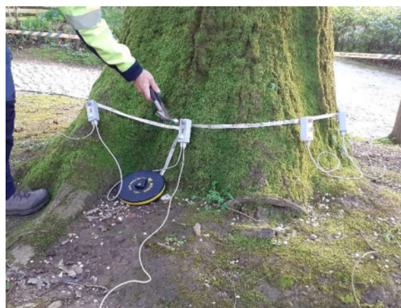
Figura 1 – Análises instrumentais com recurso a arbotom (exemplar ID 290).
