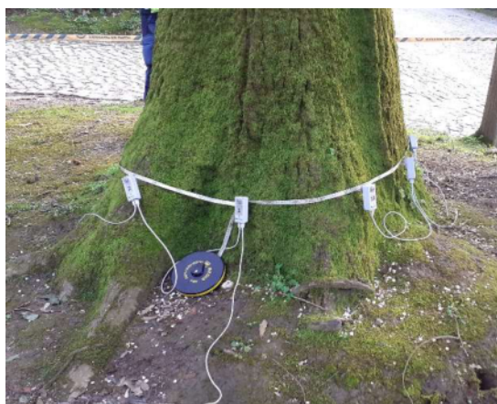
Figura 1 – Análises instrumentais com recurso a arbotom (exemplar ID 290).
