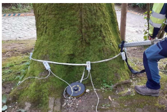
Figura 2 – Análise instrumental com recurso a resistógrafo PD-500 (exemplar ID 290).
