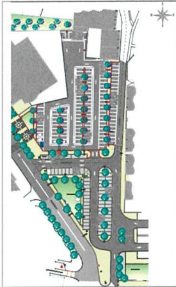
Planta de Implantação do Parque de Estacionamento
